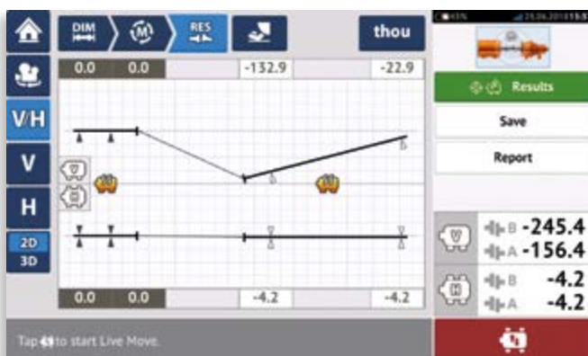
Abb. 5: Ansicht der Spezifikationsergebnisse oder Kaltausrichtung
